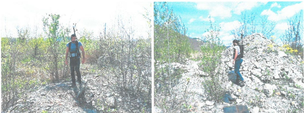
Fig. 10. Colectarea datelor cu magnetometrul GSM-19
