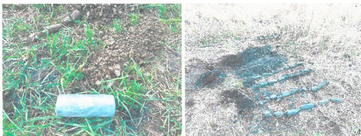
Fig. 8. Proba netulburata la F19 și forajul F12
